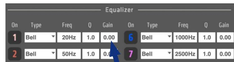
**04** Gebe den Wert für die Frequenz (Freq), die Güte (Q) und die Verstärkung/Absenkung in dB (Gain) ein
